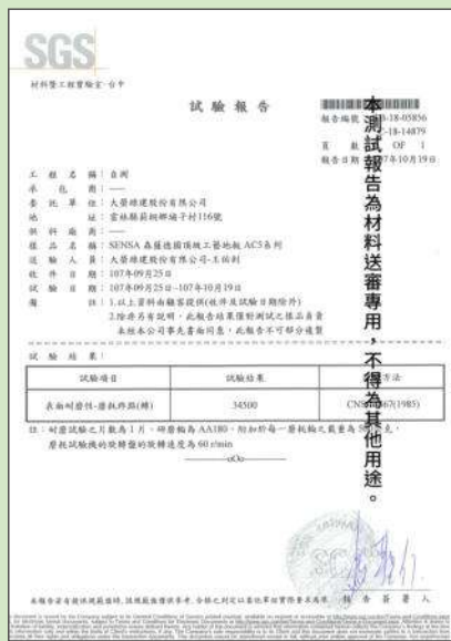
SGS表面耐磨測試 / CNS11367 (1985) AC5 34,500轉 / AC4 19,100轉
